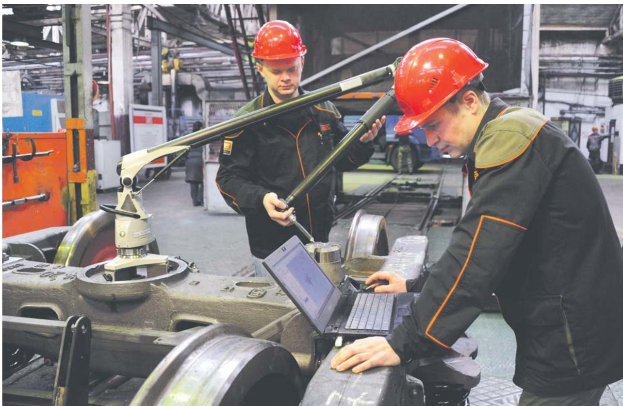
**Как быстро и точно измерить детали крупногабаритных узлов градопоезда и спецтехники? Эту задачу давно решили на Уралвагонзаводе. Переносные координатно-измерительные машины (КИМ) портативного типа отдела измерительных систем метрологической службы (34) позволяют проводить необходимые измерения, не убирая детали с конвейера или линий механической обработки. Пример использования такого современного оборудования заводские журналисты увидели в цехе вагонных тележек (380).**
